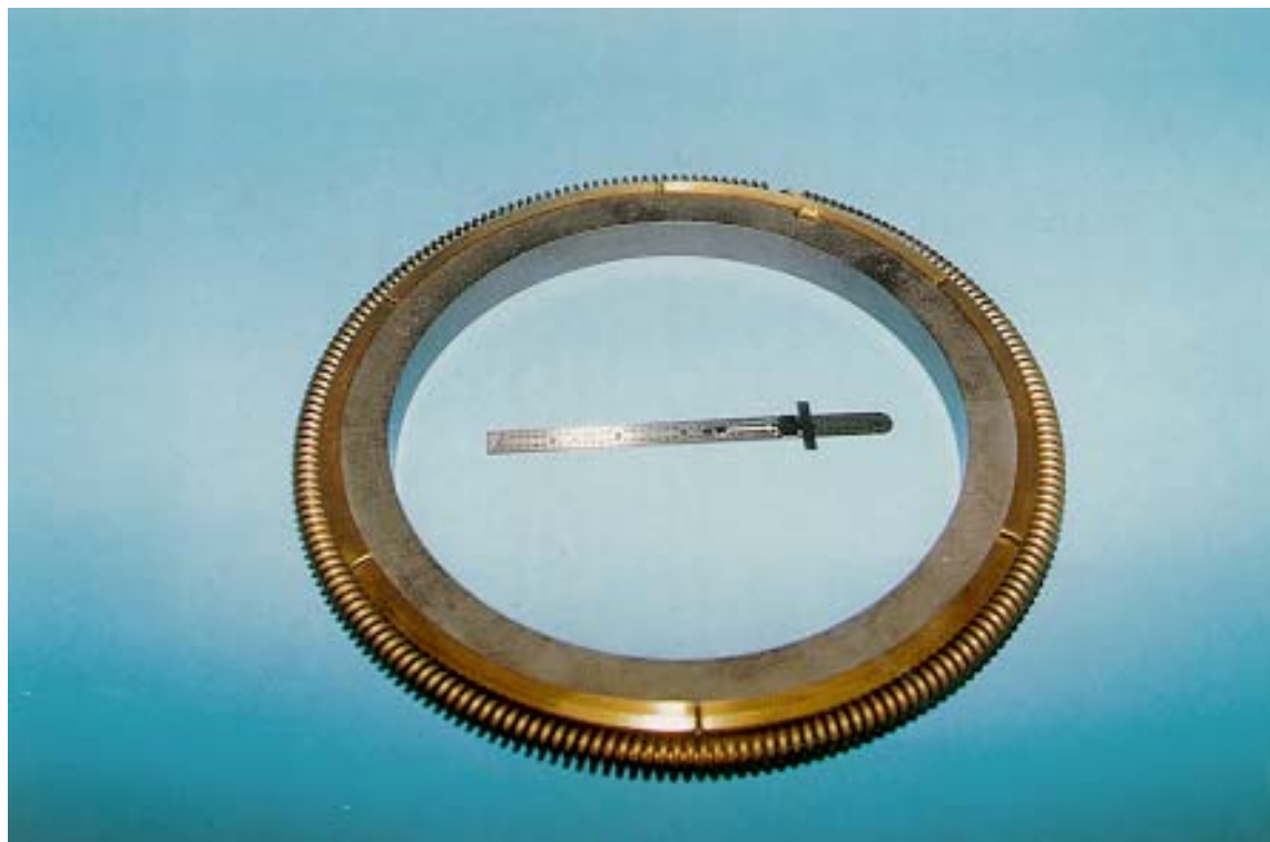
Conjunto de aro de carbono Huhn (utilizado em um gerador a turbina de vapor Elliott)
